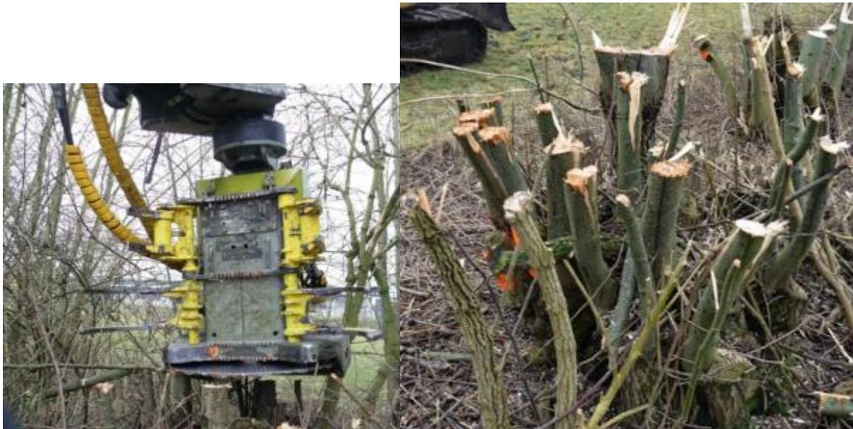
Der Fällkopf wird als hydraulisch angetriebene Einblattkreissäge oder Einblattkettenkreissäge zum Ausschneiden von Gehölzen verwendet. Die Greiferarme umfassen die Gehölze mit hohem Druck. Dadurch kommt es bereits zum Aufplatzen der Stämme.
